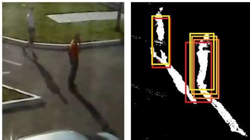
Figure 93 : Utilisation du « mean-shift » pour améliorer la localisation des personnes. Sur la personne à droite de l'image nous pouvons visualiser les 4 itérations de l'algorithme de la position précédente en rouge à la position courante en jaune.
