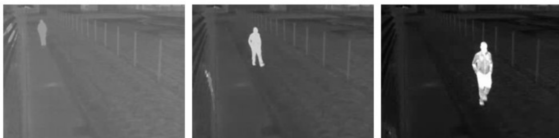
Figure 44 : exemple de correction de gain d'une caméra thermique sur une même séquence. En s'approchant de la caméra, la personne, dont la température est significativement différente du reste de la scène, occupe de plus en plus de place dans l'image. Afin d'améliorer le contraste sur la personne, la caméra assombrit tout le reste de la scène.
