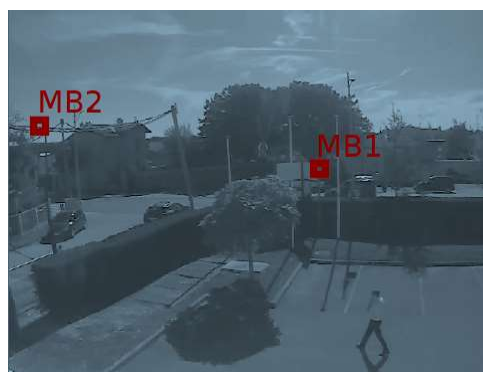
Figure 12 : localisation de deux macro-blocs MB1 et MB2 dans l'image.
