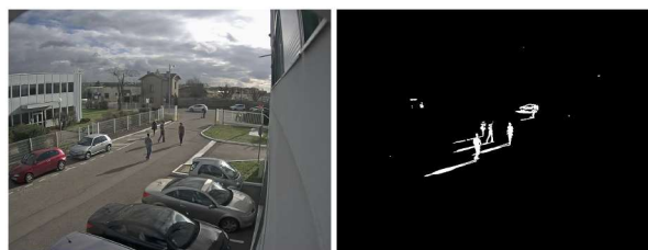
Figure 51 : exemple classique d'une mauvaise classification de l'ombre projetée par les objets. Sur l'image de gauche nous pouvons remarquer que les quatre individus sont bien isolés les uns des autres. Sur le masque de mouvement (à droite), ils sont, par contre, rassemblés sous un même blob.
