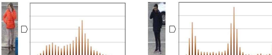
Figure 88 : exemple de représentation d'un histogramme en niveau de gris de deux personnes
