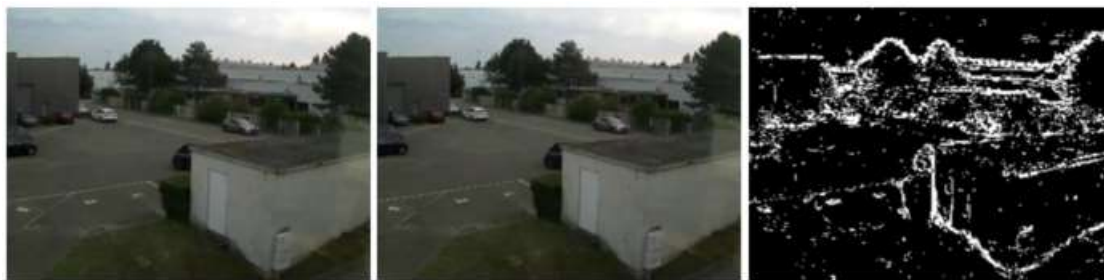
Figure 45 : exemple d'une mauvaise caractérisation des pixels en mouvement liée aux vibrations entre deux images successives. Le masque de mouvement, construit à partir de la différence entre les deux images, montre des détections de mouvement sur les zones à fort gradient.
