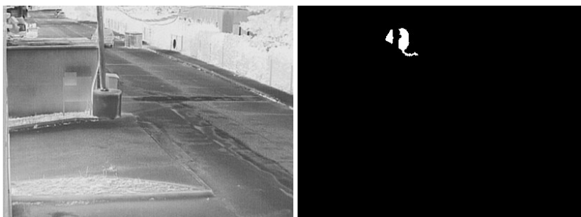
Figure 74 : exemple d'occultation partielle d'un véhicule passant derrière un poteau électrique. Le masque de mouvement (à droite) présente deux blobs distincts.
