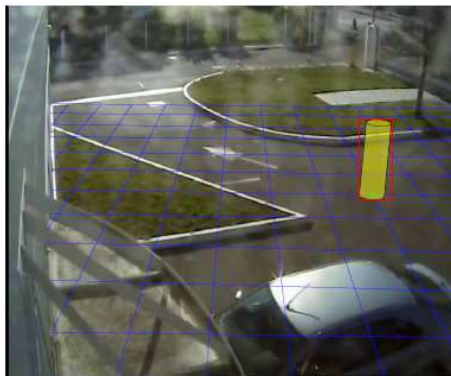
Figure 63 : exemple de projection d'un cylindre représentant un piéton dans une scène préalablement calibrée. La grille (en bleu) permet de visualiser le plan pour z=0 (le sol). Le cylindre (en jaune) est la projection de notre modèle cylindrique de personne et le rectangle rouge représente le rectangle englobant.
