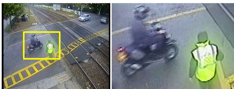
Figure 79 : exemple d'effet de flou lié au déplacement rapide d'un objet. Sur cette image, le piéton et le fond de la scène sont net alors qu'un effet de « peigne » caractéristique des caméras « entrelacées » se manifeste sur le motocycliste.
