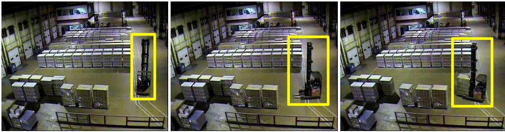
Figure 76 : exemple de changement d'apparence d'un objet en fonction de son orientation. Sur cet exemple, nous pouvons également anticiper une difficulté supplémentaire où sur l'image de droite, le véhicule transporte une palette.
