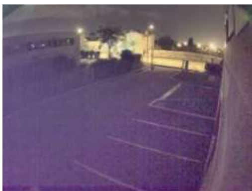
Figure 42 : exemple de bruit lié au capteur. Il se manifeste par la présence aléatoire de grain dans l'image
