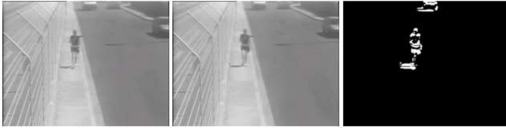
Figure 54 : exemple de détection incomplète d'une personne qui marche dans l'axe de la caméra. Dans cet exemple nous avons volontairement utilisé une constante de temps faible pour illustrer le problème. La couleur de la robe étant uniforme, elle est apprise par le modèle de fond.
