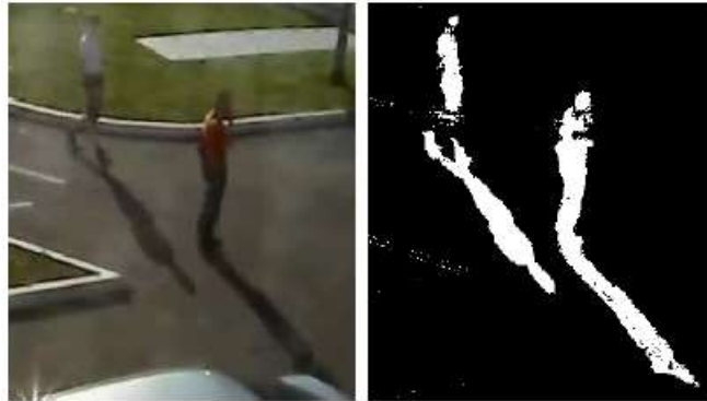
Figure 62 : exemple d'une image avec son masque de mouvement associé
