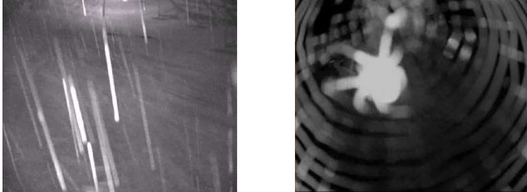
Figure 20 : exemple de capture d'une caméra avec éclairage infrarouge intégré : pluie (à gauche), araignée (à droite).
