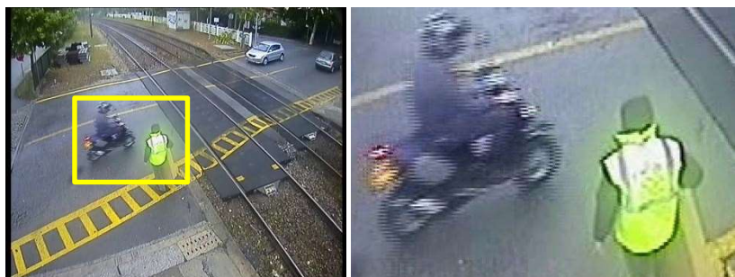
Figure 79 : exemple d'effet de flou lié au déplacement rapide d'un objet. Sur cette image, le piéton et le fond de la scène sont net alors qu'un effet de « peigne » caractéristique des caméras « entrelacées » se manifeste sur le motocycliste.
