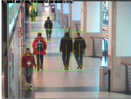
Figure 105 : exemple d'étiquetage d'une vidéo du jeu de donnée CAVIAR [208] où les personnes sont représentées par une boîte englobante et où la position de la tête, des mains et des pieds sont repérées par un cercle.
