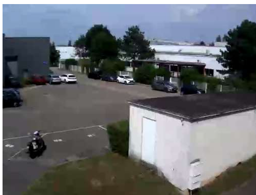
Figure 43 : exemple de bruit lié à la compression. Dans cette image il est plus visible sur le ciel et se manifeste par la coupure franche et aléatoire entre les blocs mais également d'un « GoP » à l'autre.
