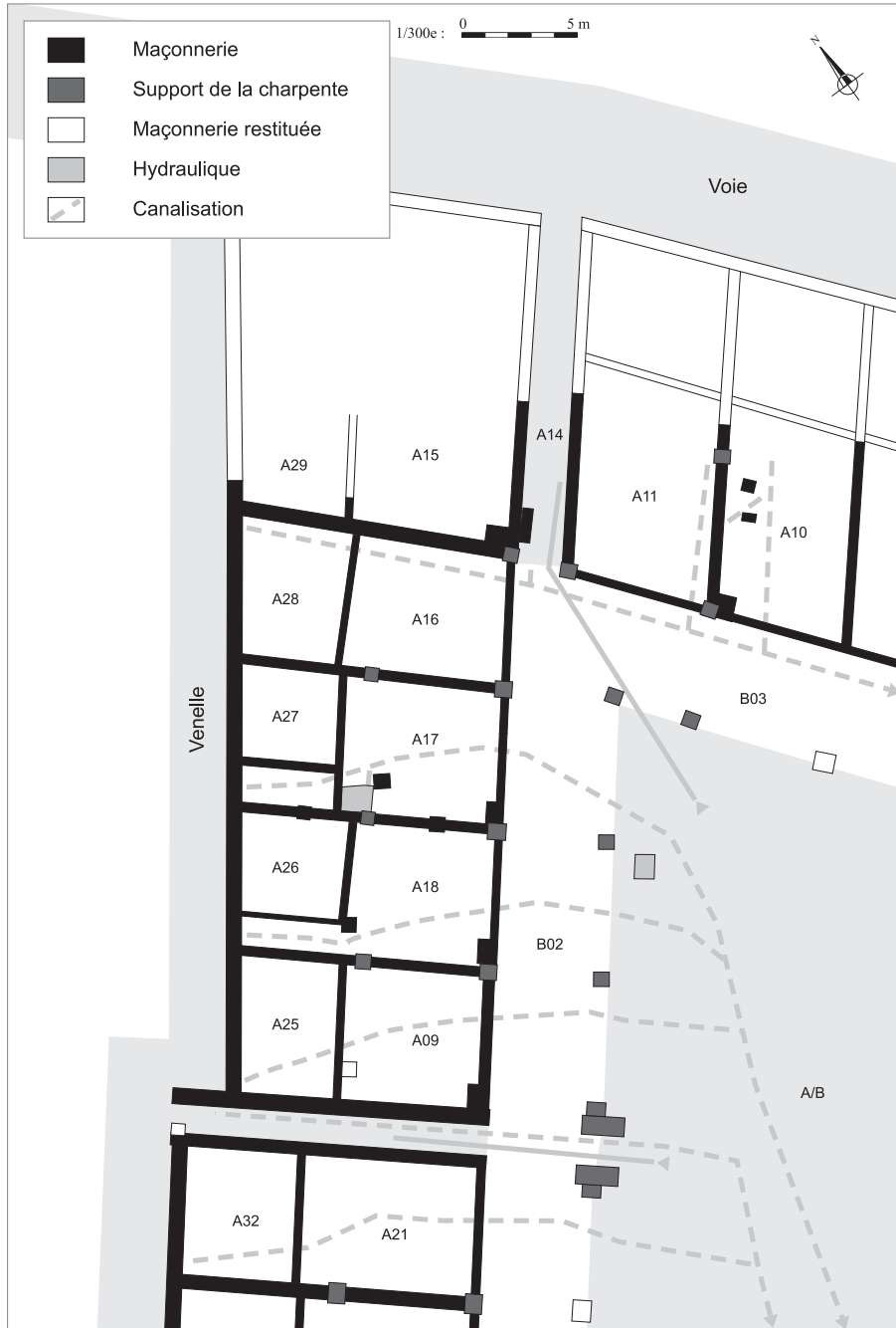
Fig. 3. Système constructif de l'aile nord-ouest du complexe commercial A-B (éch. : 1/300 e ) (DAO : B. Clément)
